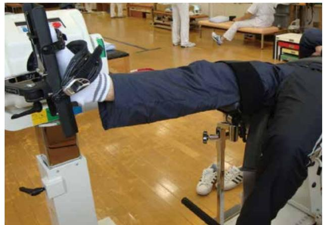
図3. BIODEXでの受動的トルク測定方法
