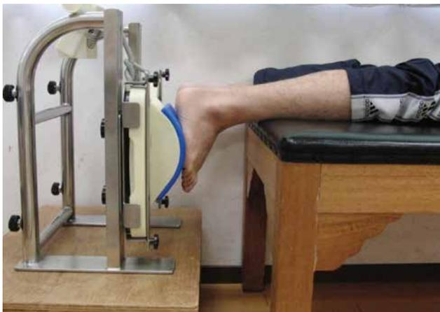
図2. QTMでの受動的トルク測定方法
